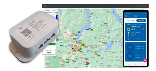
Il **DST Pro** supporta i protocolli CAN Bus (SAE J1939, SAE J1979) per il recupero dei dati dal telaio del veicolo. Integrando un set di algoritmi brevettati il dispositivo è in grado di rilevare la qualità dello stile di guida dai moti inerziali del mezzo e di fornire un feedback real-time all'autista tramite un'apposita **interfaccia**.
